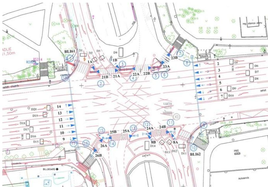
obr. 41. Označenie detektorov križovatky K214
